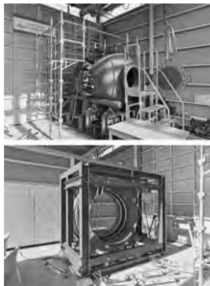
耐久性試験設備の一つである水圧試験機（上が内水圧試験機、下が外水圧試験機）
