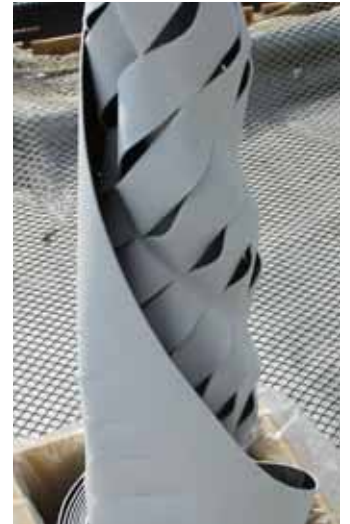
地覆キュアが給水後、取り出す
