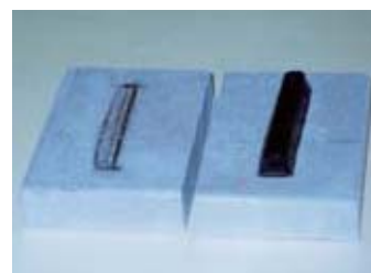
引き離し後、シール材の損傷なし
